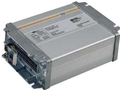
本控制器是为集中或分散式控制系统开发，专门针对室外 移动车辆工作的恶劣环境应用场合，集逻辑控制判断、运算和控制功能于一体，善于实现对电液系统实时、可靠而 又有效控制的一种新型控制器。 本控制器拥有数量众多的高性能模数输入、输出端口，能够采集诸如压力、温度、数度、水平度以及长度等物理量，同时去驱动电有磁阀、液压比例阀或者液压泵，液压马达等。 PWM 输出信号不必通过外接的放大电路或者保护转换电路，就可以直接驱动电流比例阀。 同时运用四路模拟反馈输入信号，可以完成诸如闭环控制、比例度控制、最小最大电流限制等众多功能，从而可满足不同类型的电磁阀控制要求。 使用该控制器能够给系统带来更好的安全性能 具有 独立的处理器监视器( 看门狗)、输出闭锁、 在复位状态可以定义所有输出为非活动状态，欠压和过载监视活动，输入可读反馈，输入测试功 能，温度监视等。
